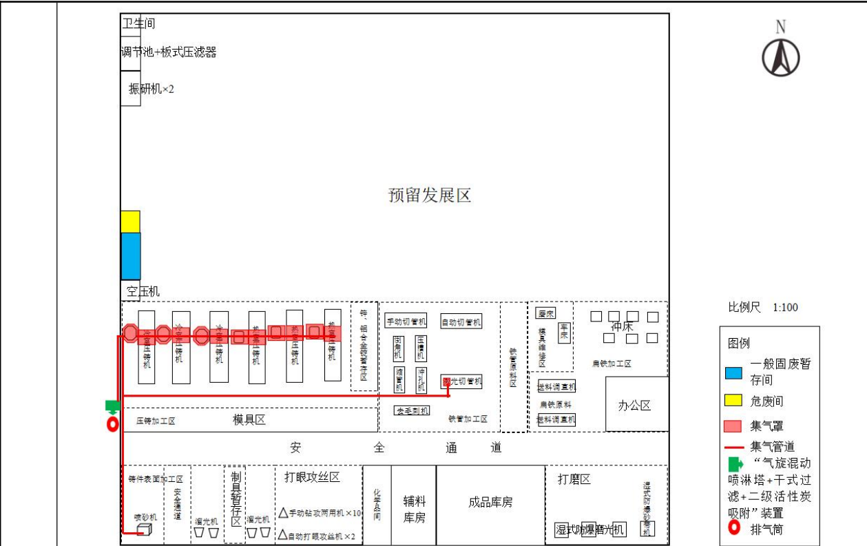
图 4-1 生产车间废气收集、处理及排放走向图
